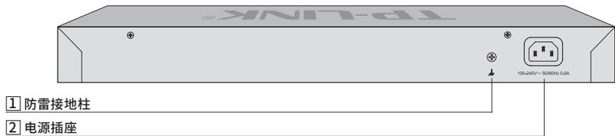
图1-2 TL-SG6428后面板示意图
