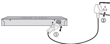
图3-4 电源线连接示意图
